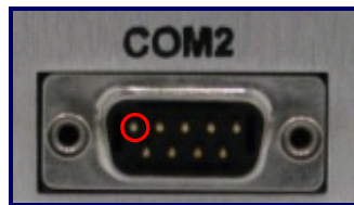
Enclosure TS-540 COM2 Port, Pin 1
